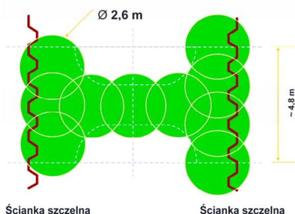
Rozmieszczenie kolumn na bazie \varnothing 2,6\text{ m}
